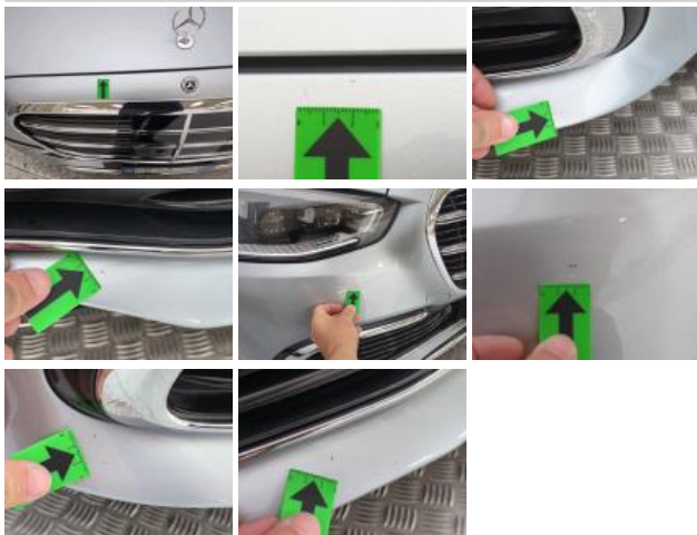
Cofano anteriore, Scheggiatura da pietrisco, 1 - Lieve Min
